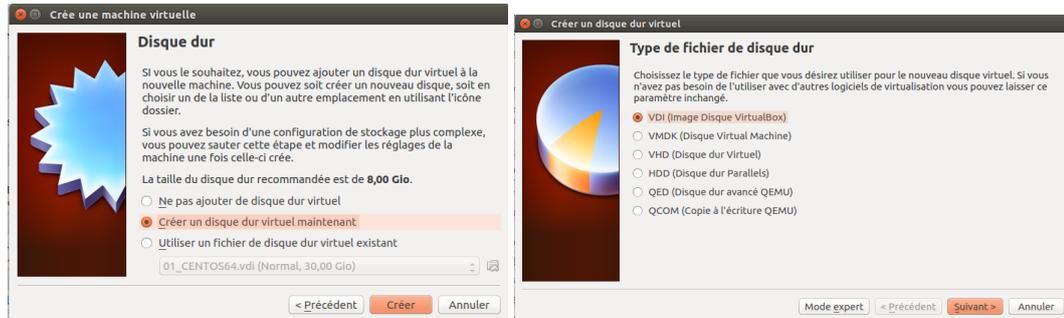
FIGURE 2.10 – Création d'un disque dur virtuel de type VDI
