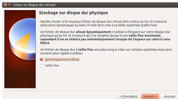
FIGURE 2.11 – Disque dur type statique ou dynamique
